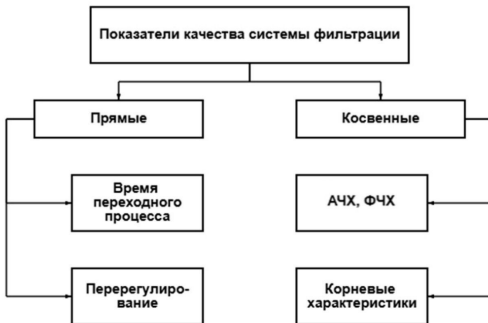
Рисунок 1.6 – Схема показателей качества системы фильтрации
